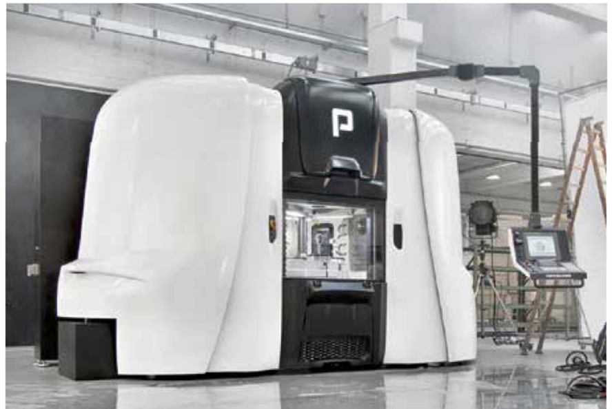
1 Imposante Erscheinung mit ›inneren Werten‹: Das 3-spindlige Multicenter sortiert sich zwischen BAZ und Transfermaschine ein und punktet mit hoher Produktivität (© Porta Solutions)
