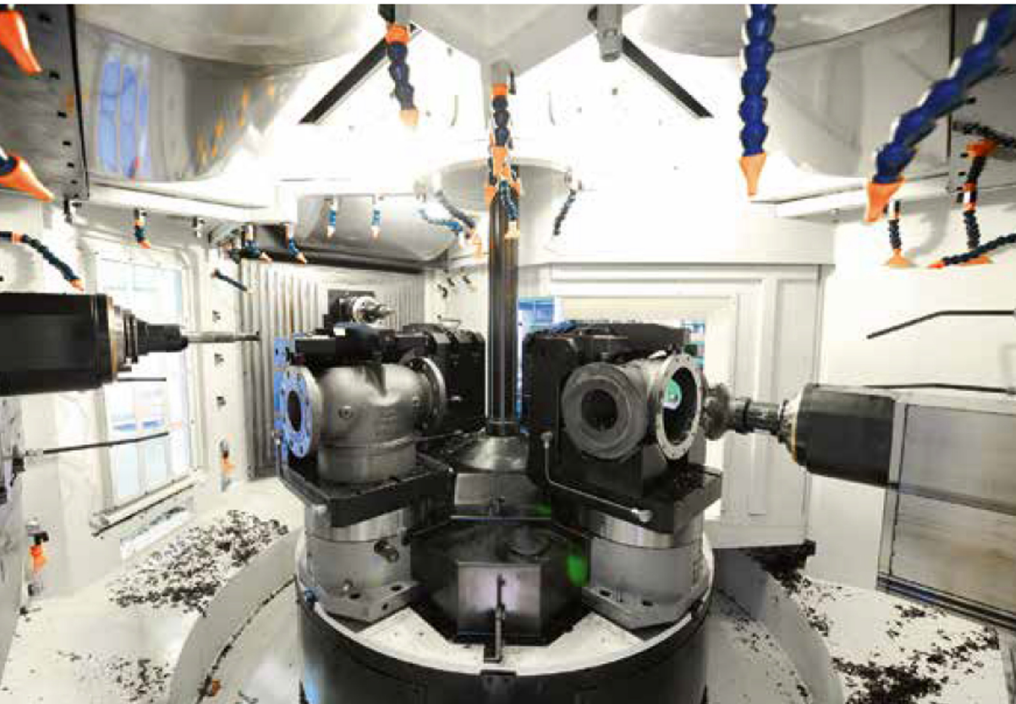
2 Mit drei Spindeln schneller zum fertigen Teil, bei hoher Präzision und weniger Umspannvorgängen (© Porta Solutions)
